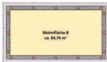
29 cm Wandstärke (Holzständerwand mit StoTherm Wood)
